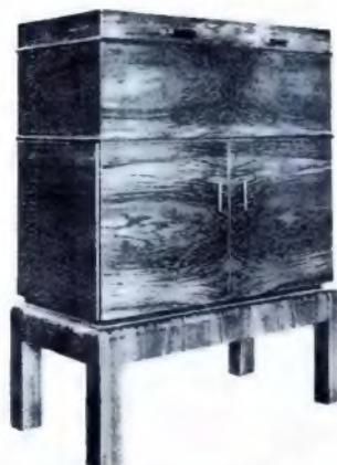
Der Vogtsche Oszillofar, ein 7-Röhrenneutroden erlesener Ausführung mit eingebautem Wechselstromnetzanschluss.
